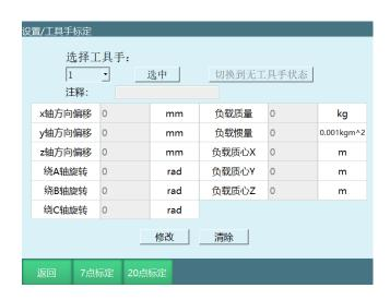
若有工具的详细参数,在该界面下,用户可以直接填写工具末端偏移的相关参数,不需进行七点标定。
