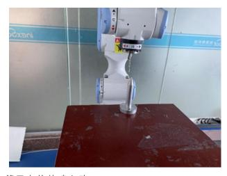
第六个点: 机器人在第五点的基础上动 Y+
