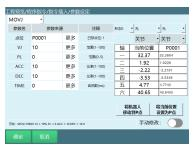
当前位置列显示当前选中的坐标系下的机器人位置; P0001 列显示 P 点选中坐标系下的机器人位置
