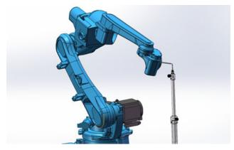
第十二点机器人在第十点的基础上,通过直角坐标系做 A-,旋转 90°, J5<-90°,尖端对齐标定第十二个点;
