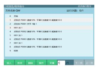
运行到第 6 行时 P0001 J1=1、I001=2, 切换示教模式产生断点, 切换到示教模式后查看 P0001,I001 显示为初始值, 此时按【DEADMAN】上电, 显示为 P0001 J1=1、I001=2, 下电恢复初始值
