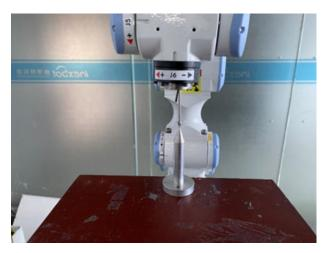
第二个点: 机器人在第一点的基础上 C 轴旋转 180°
