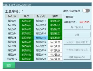
找到一个参考点(标定锥尖端为参考点),并确保此参考点固定。 开始插入位置点,每插入一点,点击【标记该点】,插入十五个点具体步骤如下:
