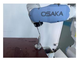
第四个点: 机器人回到零点, 然后工具手末梢垂直
