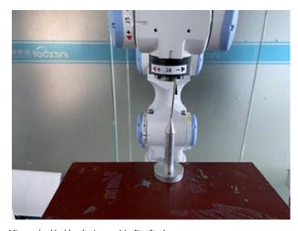
第三个点: 机器人在第一点的基础上 B 轴角度在 35°
