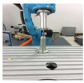
TC4 标定:将机器人切换一个姿势,末端正对参考点,点击该行所对应的【标定】按钮,如下图所示。
