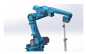
第十个点机器人回到第一个点,通过关节坐标系点动五轴,使五轴向上,J5<-90°,将尖端对齐,标定第十个点;
