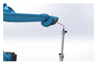
第五个点在第四个点的基础上,通过直角坐标系做 B+, J5>-90°,将机器人尖端对准标定锥尖端,标定第五个点;
