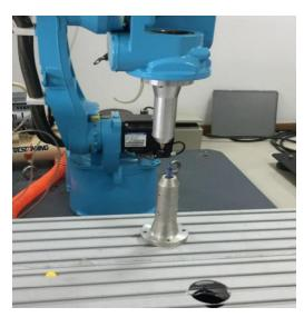
TC7 标定: 在 TC6 的基础上,沿笛卡尔坐标系 Y 轴正方向移动任意距离,点击该行所对应的【标定】按钮,如下图所示。
