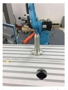
将工具末端垂直且正对参考点,点击界面"TC1"所对应的【标定】按钮,如下图所示。
