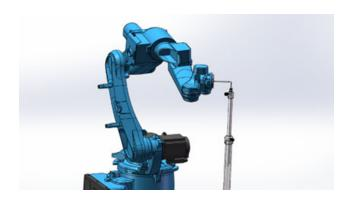
第九个点在第七个点的基础上,通过直角坐标系做 A-,旋转 90°, J5>-90°,尖端对齐标定第九个点;
