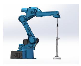
第二个点在第一个点的基础上,通过直角坐标系将 C 旋转 180 度;尖端对齐标定第二点;第三个点机器人回归零点,通过直角坐标系将机器人尖端对准标定锥 尖端;标定第三个;(与第一个点相同)
