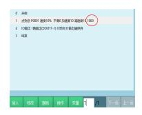
MOVJ指令后插入 DOUT 指令; MOVJ指令 TIME 参数填 1000ms, 则运行时会提前 1s 执行下一条指令, 例如 MOVJ指令会执行 3s, 则 MOVJ指令运行 2 秒执行 DOUT 并继续执行 MOVJ到 P0001。
